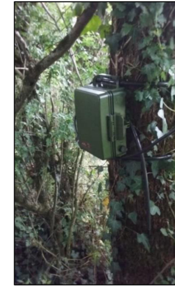
Figure 221 : Installation d'enregistreur continu SM4BAT (Source : NCA Environnement)
